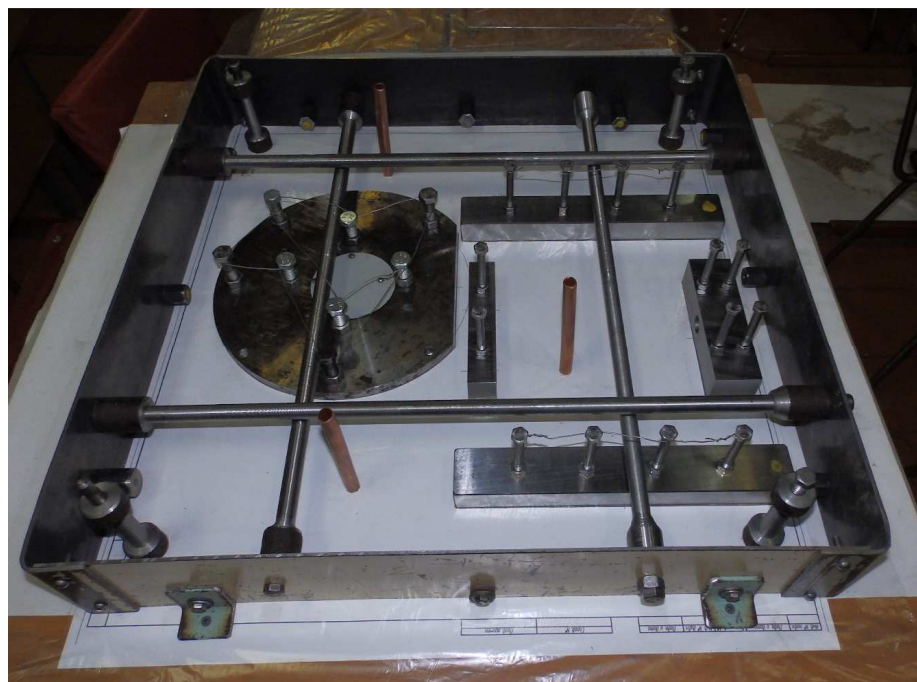
Рис. 1. Форма с арматурой и системой закладных элементов
